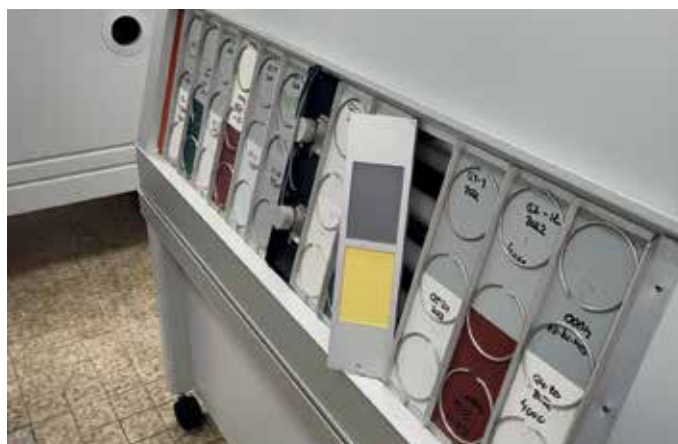
Laboratoriumapparatuur om UV-bestendigheid te testen
